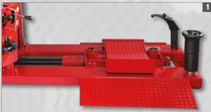
**1.** Il telaio, struttura portante dello smontagomme, utilizza nuove soluzioni tecniche per offrire più robustezza e minori flessioni durante le fasi di lavoro con ruote impegnative.
