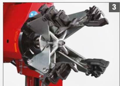
**3.** Garras de bloqueio de topo de gama. Bloqueio de 14" **até 26"**. Desempenho máximo graças aos 7 métodos de bloqueio disponíveis. **Diámetro mínimo de garra: 100 mm.** São fornecidos passadores de plástico para suporte do aro, com diferentes espessuras, para um perfeito bloqueio do aro.
