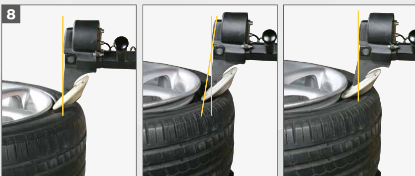
8. Système de pénétration contrôlée pour simplifier le détalonnage des roues les plus difficiles (Patent Pending) System des kontrollierten Eintritts zum einfachen Abdrücken selbst schwierigster Reifen (Patent Pending).
