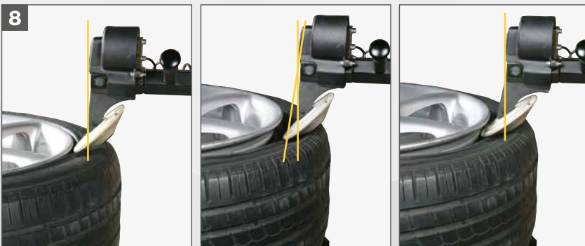
8. Sistema de penetración controlada para simplificar la destalonadura de las ruedas más complicadas (Patent Pending).
