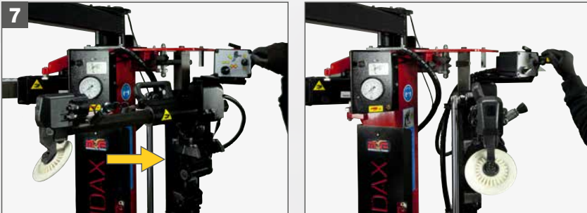
7. Grupo Destalonador Movimiento de accionamiento neumático de apertura lateral del brazo para permitir la colocación en el flanco inferior.
