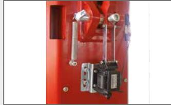
Entriegelung der Sicherungen mit **Elektromagnet 24V**
